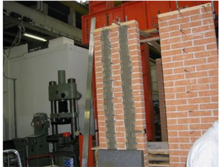
Foto 8. Multiklæb påsmøres i baner, hvor armeringen skal placeres, hvorefter armeringen "trykkes" ind i denne
