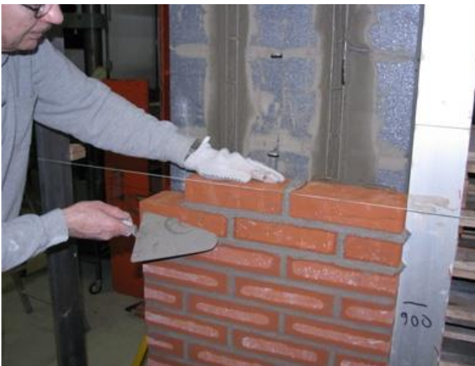
Foto 18. Formuren opføres inden Multiklæb på EPS er hærdnet helt op
