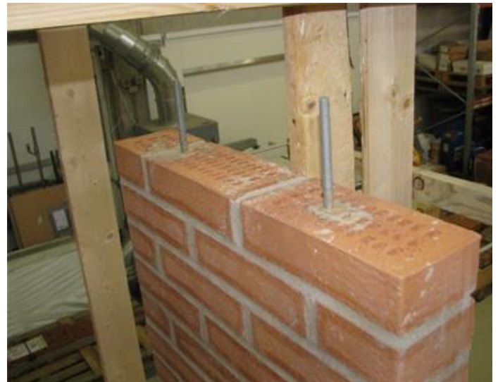
Foto 6. I top er indlimet 2 gevindstænger i de øverste 3 skifter. Mange forskellige løsninger kan anvendes ved forankring af toppen.
