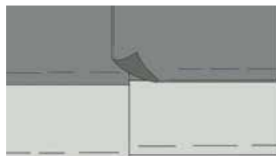
Skarvning av Joma GF Kombiplåt.
